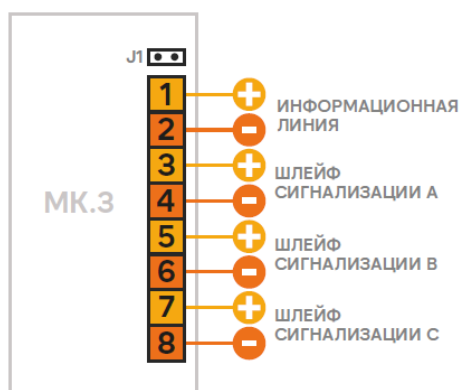
Рис. 2. Назначение клемм адресных меток КУПОЛ-МК.3.
